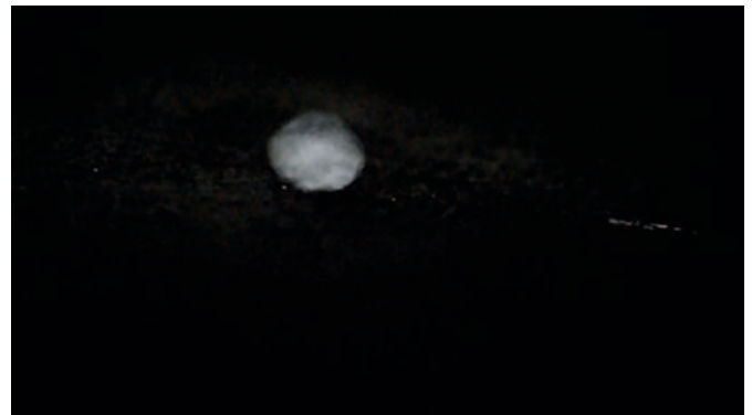
Figura 5. Gota de agua en la fase de ebullición violenta.
