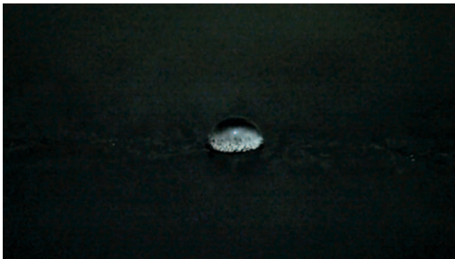
Figura 3. Gota de agua entre 104°C y 110°C.
