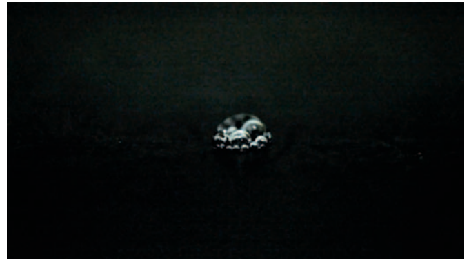
Figura 4. Gota de agua en la fase de ebullición por nucleación.
