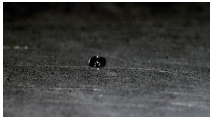
Figura 6. Gota de agua por encima del punto de Leidenfrost.
