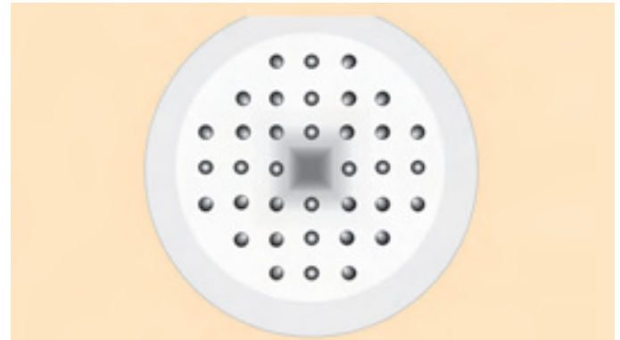
Representación esquemática de la sección transversal de una fibra óptica microestructurada. Una fibra de este tipo tiene una estructura bidimensional de índice de refracción que elimina la simetría de revolución de la fibra. La fibra representada en este esquema tiene una estructura con simetría cuadrada que tiene un defecto en el centro. Este defecto atrapa la luz —representada en rojo— y es el responsable del guiado.
