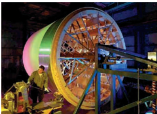
Time Projection Chamber, del proyecto STAR, en el RHIC, para registrar colisiones.
