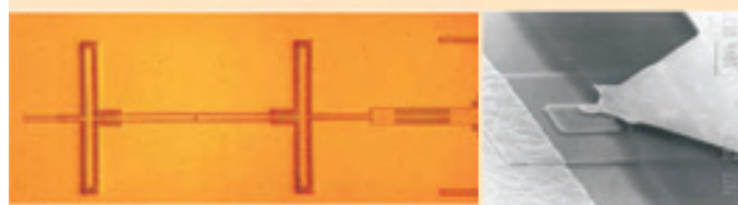
Módulo receptor micromecanizado de 38 GHz integrado monolíticamente en GaAs y detalle de la región del diodo Schottky
